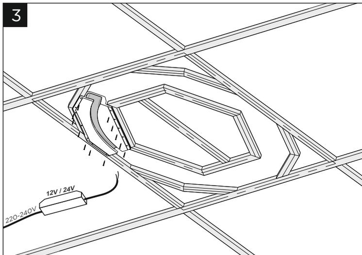
Закрепите 1/6 часть светильника к каркасу потолка с помощью саморезов для гипсокартона.
