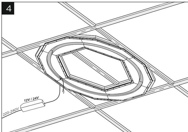
Далее закрепите остальные части светильника к каркасу потолка с помощью саморезов для гипсокартона и заведите питающий кабель во внутрь корпуса светильника через техническое отверстие.
