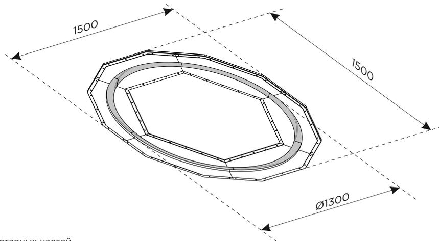
Гипсовый корпус светильника CALYPSO 1300 состоит из 6-ти составных частей.
