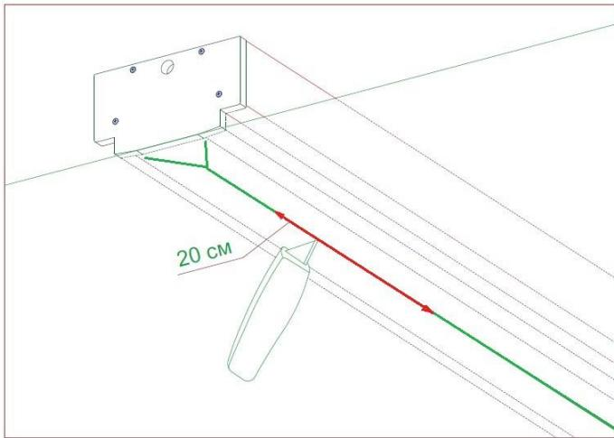
14. Для монтажа полотна в трек необходимо использовать монтажный шпатель.(рекомендуемая толщина шпателя 0,5 мм для тканевых и 0,4 мм для ПВХ материалов)
