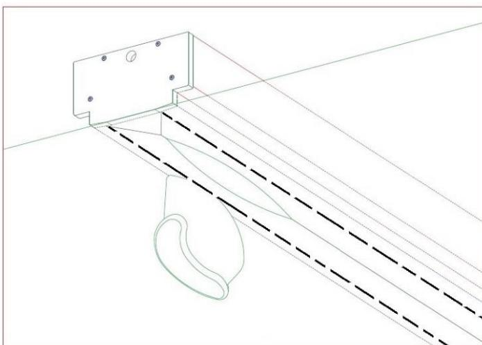
15. После заправки основной части материала оставшуюся часть полотна треугольной формы необходимо приклеить к внутренней торцевой заглушке.
