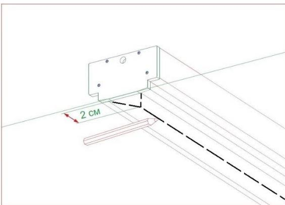
13. Начинать монтаж необходимо с середины трека, плавно подходя к торцам. Используя нанесенную отметку сделайте разрезы полотна сегментами по 20-30 см и заправьте материал в пазы трека.
