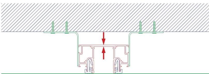
9. Закрепите трек к поверхности потолка с помощью монтажных уголков и саморезов. (длина саморезов не должна превышать 13 мм.)
