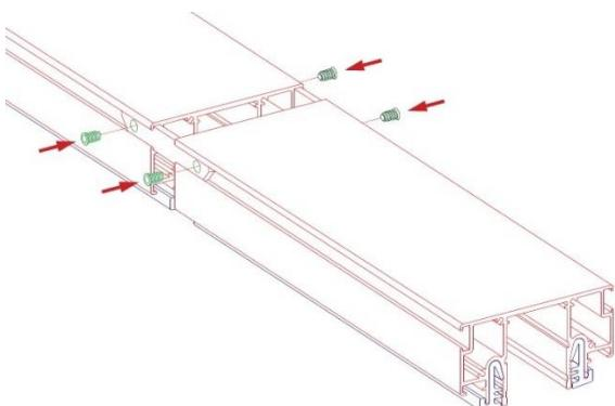
4. Надежно соедините части трека с помощью винтов при помощи шестигранного ключа (ключ в комплект не входит).
