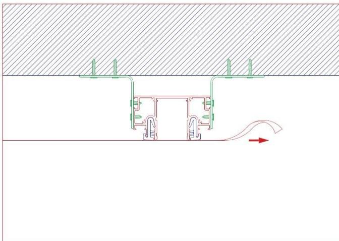
12. С помощью карандаша сделайте отметку на полотне вдоль всего трекапо середине, не доводя линию до торца около 2 см, и от неё сделайте отметки к углам торца трека.
