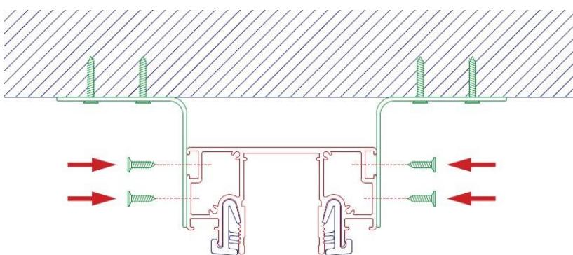
10. Определите место подключения и установки блока питания или коннектора для питания трека. В зависимости от его типа, подключение происходит либо через торцевую заглушку, либо через отверстие в профиле трека. Подключите и установите коннектор питания в трек.
