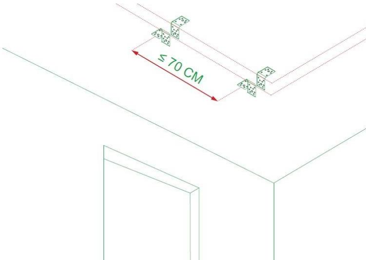
8. Нижний уровень трека необходимо установить в плоскости установки натяжного потолка при помощи лазерного нивелира.
