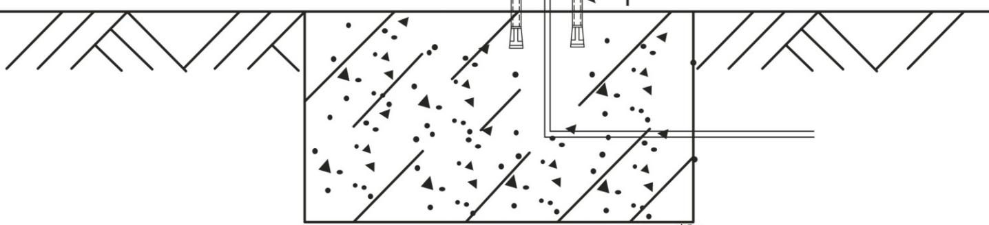
1. Установите в жесткую бетонную поверхность крепежные винты /идут в комплекте/.
