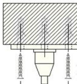
1. Просверлите отверстия в потолке. Для определения положения отверстий используйте круглую оконцовку трасса.
