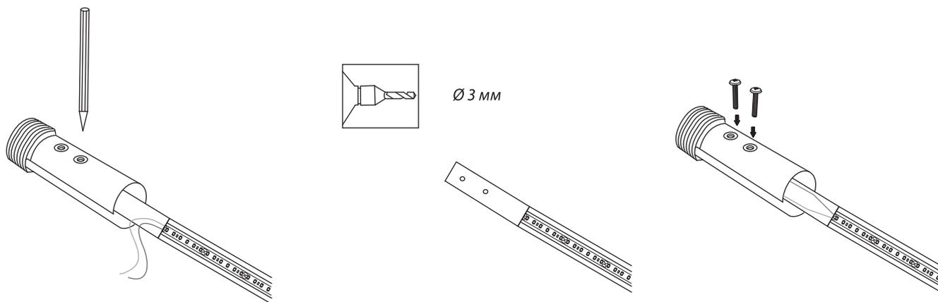
Предварительно вставьте металлическую полосу (1) в зажим крепления (3), сделайте разметку карандашом для двух отверстий. Просверлите отверстия диаметром 3 мм по отмеченным меткам в металлической полосе. Установите металлическую полосу в зажим (3) и зафиксируйте двумя винтами.
