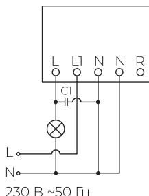
Если при работе сенсорного диммера лампа имеет небольшое свечение или диммер не реагирует на включения и выключения, то необходимо в цепь питания нагрузки установить конденсатор «C1». Конденсатор емкостью 0,1-микрофарад/275 В.
