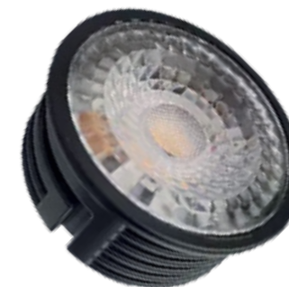
ST9101.449.07 DIM ■ черный ST9101.549.07 DIM □ белый LED-модуль DIM напряжение — 220-240 V мощность — 7 W световой поток — 560 LM цветовая температура — 4000 K индекс цветопередачи — 80 RA диммирование — да угол рассеивания — 60° размер — D50 × H20 MM
