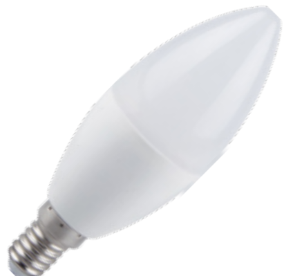
ST9100.148.05 AROUND LED smart лампа цоколь — E14 типоразмер — C37 напряжение — 220-240 V мощность — 5 W световой поток — 500 LM цветовая температура — 2700–6500 K CCT индекс цветопередачи — 80 RA диммирование — да угол рассеивания — 180° протокол связи — Wi-Fi 2.4GHz голосовое управление — Yandex Алиса; Siri размер — D37 × H113 MM
