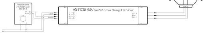
2. Схема подключения контроллера и драйвера без отдельного блока питания шины DALI (DT 8)
