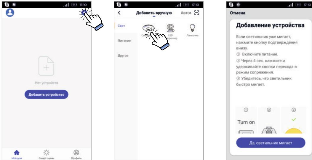
3. Включите светильник настенным выключателем. Через 4 секунды (но не позже чем через 8 секунд) нажмите и удерживайте на пульте кнопки сопряжения, отмеченные значком . Вход в режим сопряжения сопровождается миганием света (около 2-х раз в секунду).
